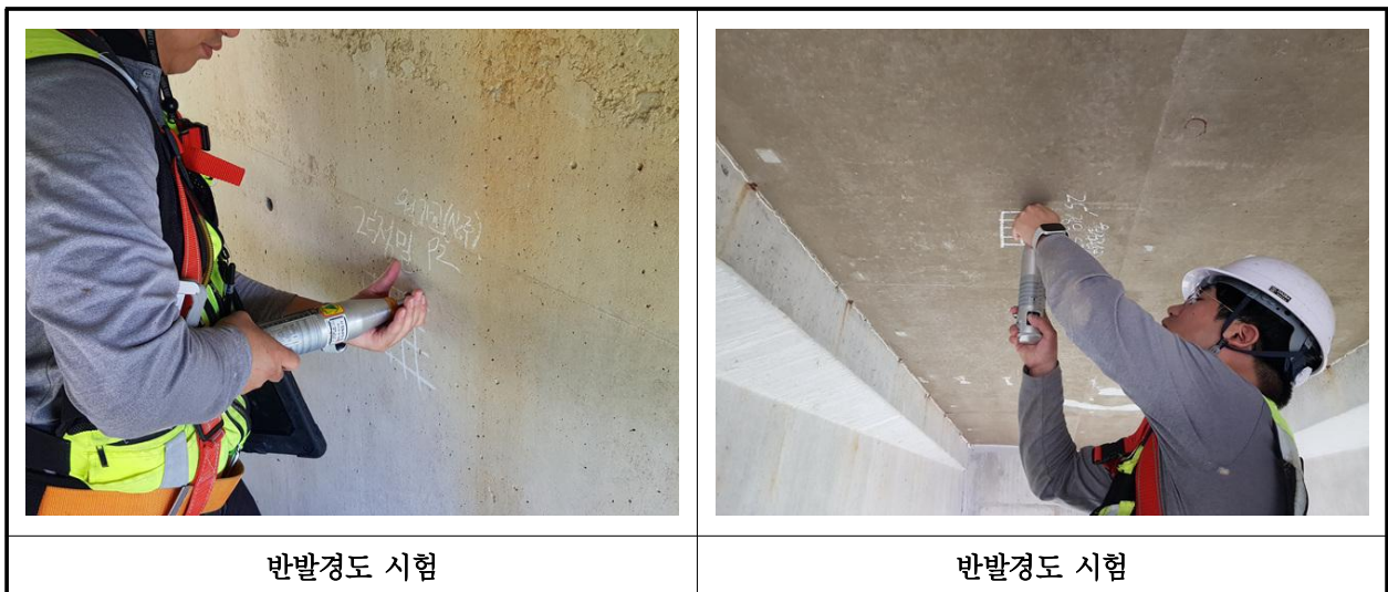
【사진 7.4.2】 반발경도시험 현장사진
